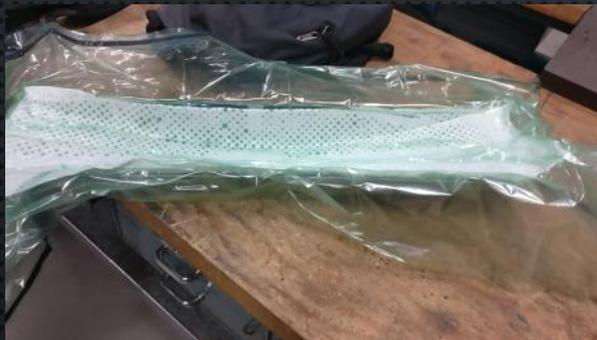
Mise sous vide et polymérisation à température ambiante
