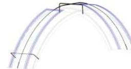
Conception de l'arche : forme en H, faible épaisseur dans les zones non contraintes, renfort sur la couronne intérieure des flans. Masse calculée 330 g.
