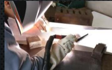
Fabrication d'un moule en aluminium
