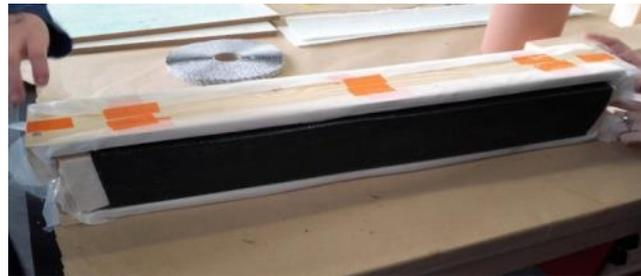
Disposition du moule en bois sur le pont drapé
