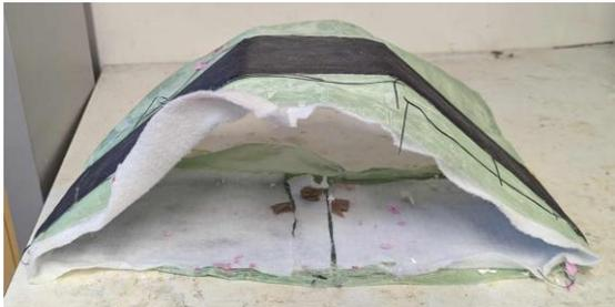
Découpe des 3 parties du trapèze et assemblage à l'aide de résine
