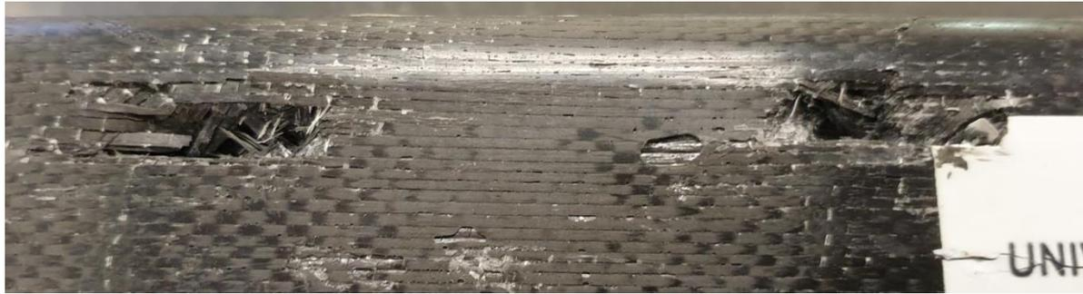
Rupture au cisaillement d'une équerre de renfort puis perforation du tablier
